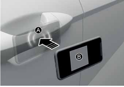
[A] Kapı kolu kimlik doğrulama alanı [B] NFC Anteni
