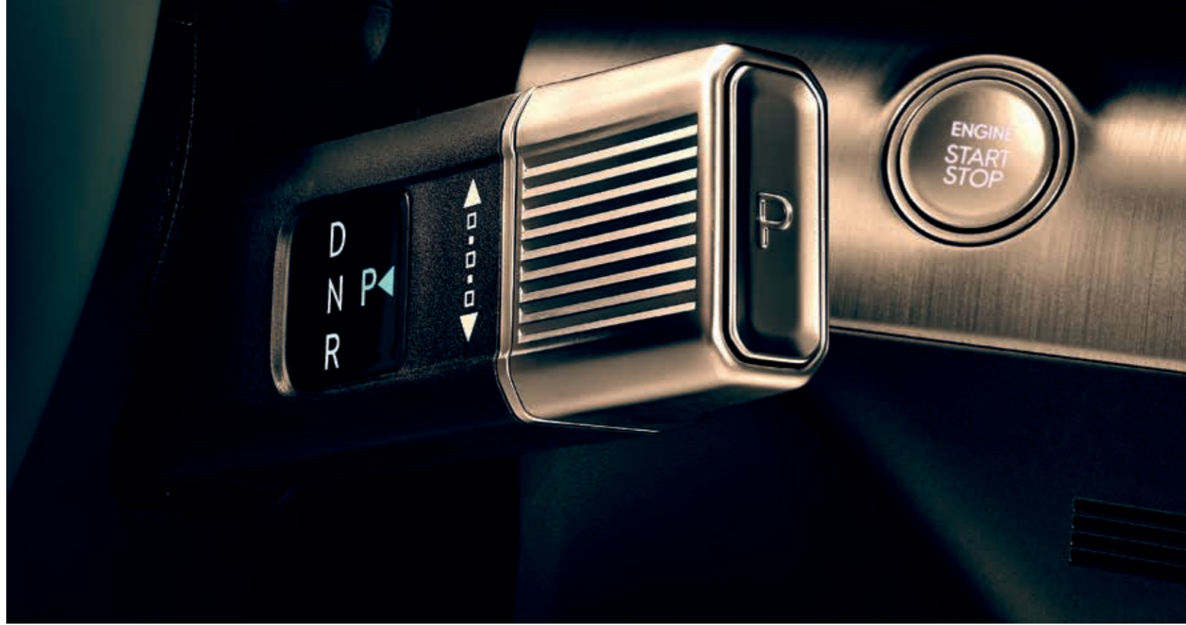
Direksiyona Entegre Vites Kolu (E-Shift By Wire)
