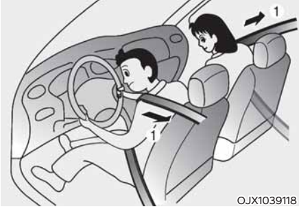
[1] : Geri Sarma Makarası Ön Gerdircili emniyet kemeri Sürücü ve ön yolcu koltuğu (varsa)
