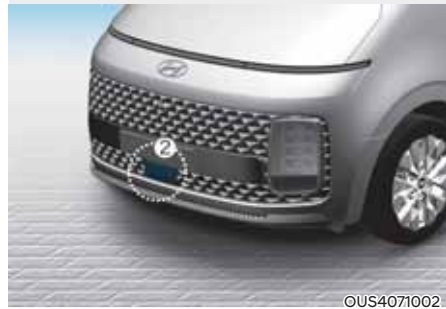
[1]: Ön görüş kamerası, [2]: Ön radar
