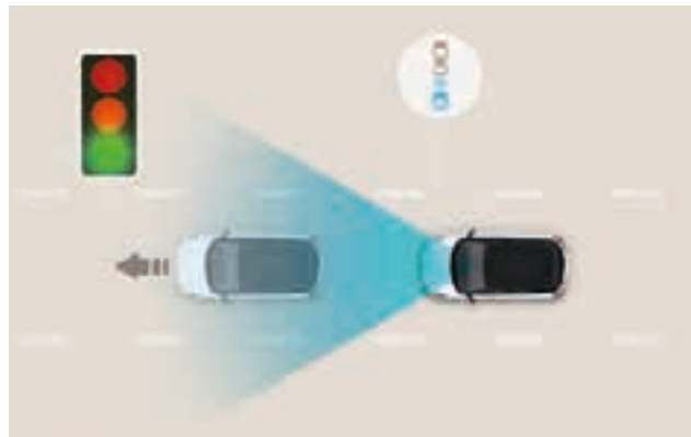
Sistema de alerta de inicio de la marcha (LVDA). Esta ingeniosa función para circular por ciudad advierte al conductor cuando el vehículo que circula delante retoma la marcha tras detenerse, por ejemplo, en un semáforo o a consecuencia de un atasco.
