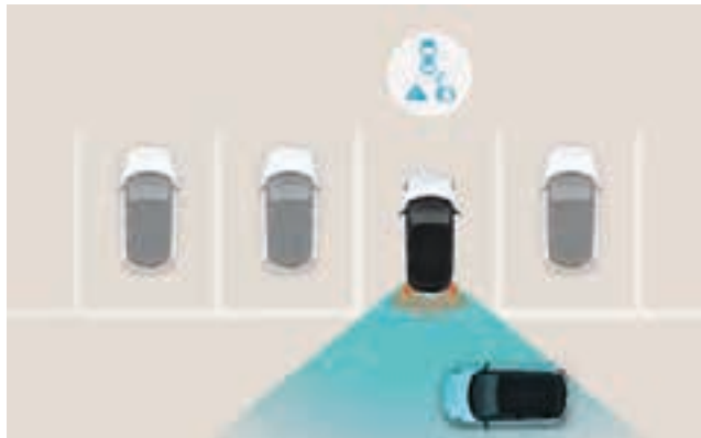
Asistente contra colisiones traseras (RCCA). Al dar marcha atrás en zonas de poca visibilidad, el sistema avisa al conductor si se aproximan vehículos por el lateral y activa los frenos de forma automática.
