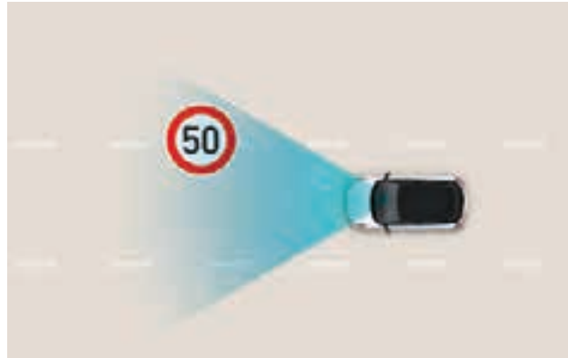
Asistente inteligente de límite de velocidad (ISLA). Este sistema emite alertas acústicas y visuales si circulas por encima de la velocidad permitida en la vía. Además, te avisa para que cambies la velocidad establecida en el Asistente de límite de velocidad manual o en el Control de crucero inteligente a fin de respetar los límites fijados.
