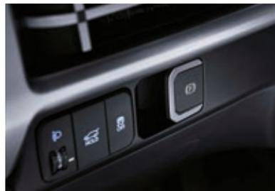
Freno de estacionamiento electrónico (EPB)
