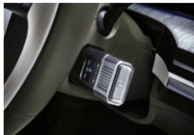
Cambio electrónico tipo columna (SBW)
