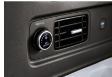
Ventilación en 3ª fila
