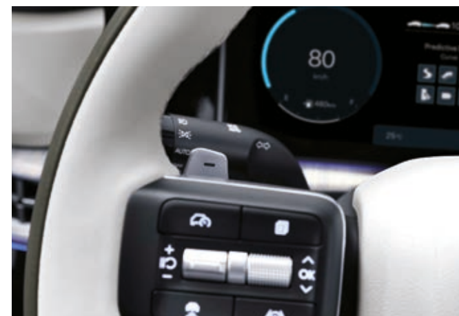
Características exclusivas del híbrido Paddle Shift (levas) - Modo de frenado regenerativo
