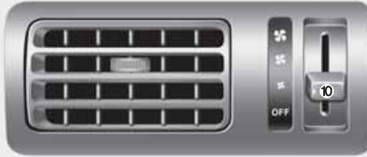
■ 3'üncü sıra havalandırma kontrolü (B Tipi iklim kontrolü)
