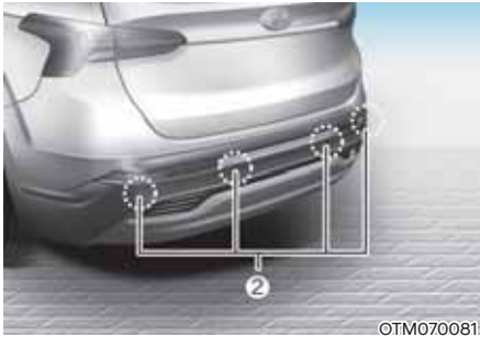
[1] : Ön ultrasonik park sensörleri, [2] : Arka ultrasonik park sensörleri
