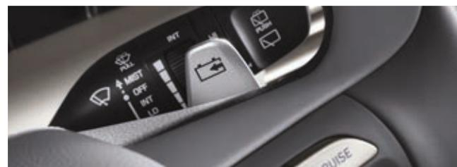
Levas para control de frenada regenerativa (control de la frenada de recuperación)
