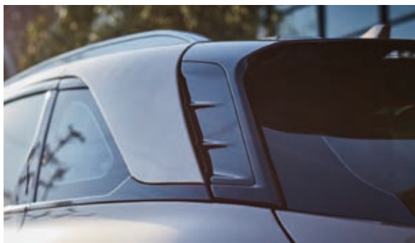
Túnel de aire situado en el pilar D
