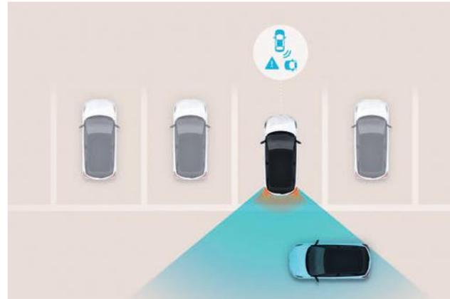
**Querverkehrswarner hinten mit Bremsassistent.**
