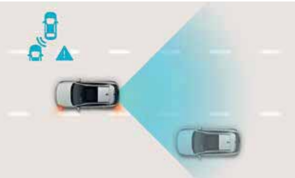
Blind-Spot Collision Warning (BCW). Grâce à un radar situé au bas du pare-chocs arrière, le système vous avertit de la présence d'autres usagers de la route dans votre angle mort. Si vous allumez le clignotant dans une telle situation, vous entendrez un signal audio et la voiture freinera pour éviter une collision.
