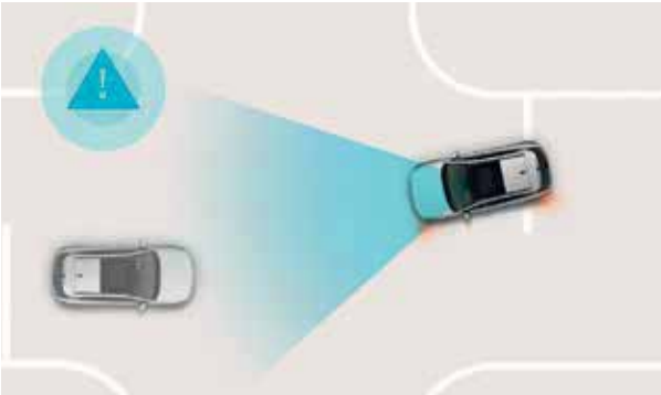
Forward Collision-Avoidance Assist with Junction Turning (FCA-JT). À l'aide d'une caméra et d'un radar, le système scanne la route et veille à ce que la voiture ralentisse automatiquement si un véhicule qui la précède freine brusquement ou s'il y a un risque de collision avec des piétons ou des cyclistes. Aux croisements, le véhicule freine en cas de possibilité de collision avec un véhicule venant en sens inverse.
