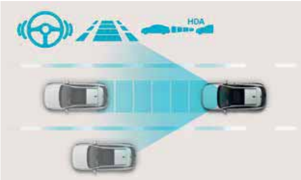
Highway Driving Assist (HDA). Le KONA Hybride est équipé de Highway Driving 1.5, qui utilise des capteurs et des données cartographiques pour maintenir la voiture dans sa voie et à une distance de sécurité avec les véhicules qui la précèdent. La vitesse est automatiquement ajustée.
