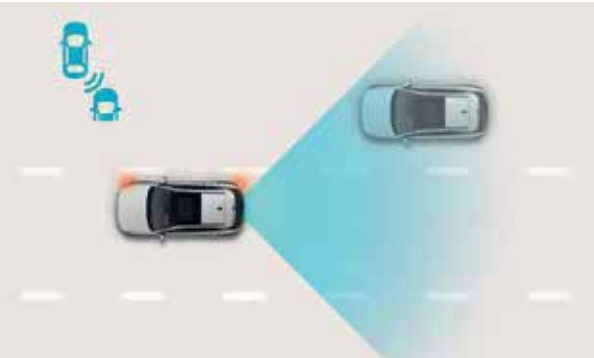
Blind Spot Collision-Avoidance Assist (BCA). Pour une conduite plus sûre dans une circulation dense, BCA vous avertit si une voiture est détectée dans votre angle mort et que vous changez de voie. Si nécessaire, le système freine et redirige la voiture automatiquement.
