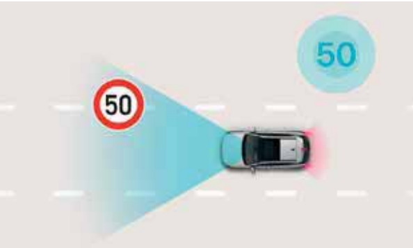
Intelligent Speed Limit Assist (ISLA). Reconnaît les panneaux de signalisation et ajuste la vitesse en fonction de la limite de vitesse en vigueur (si activé). De cette façon, vous pouvez conduire de manière semi-autonome.
