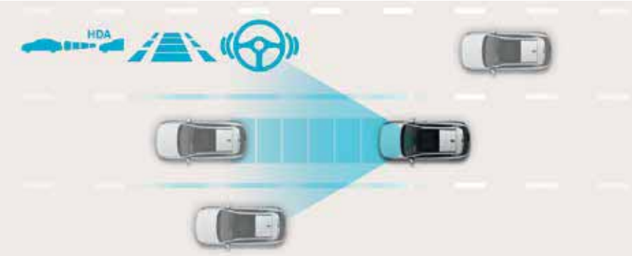
Highway Driving Assist (HDA). Le KONA Electric est équipé de Highway Driving 1.5, qui utilise des capteurs et des données cartographiques pour maintenir la voiture dans sa voie et à une distance de sécurité avec les véhicules qui la précèdent. La vitesse est automatiquement ajustée.
