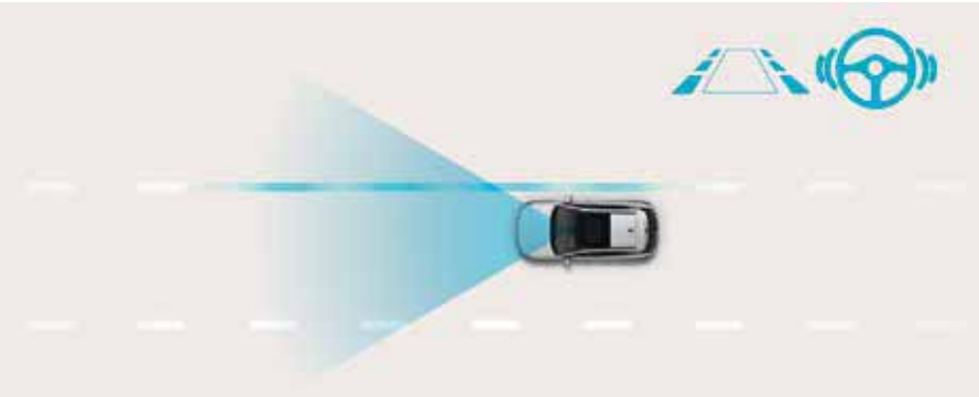
Lane Keeping Assist (LKA). Utilise la caméra avant pour surveiller les lignes de la route. En cas de sortie de voie involontaire, il vous avertit et peut appliquer un couple de contre-braquage pour ramener la voiture dans la voie.
