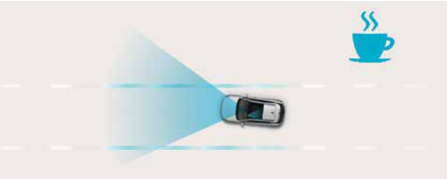
In Cabin Camera (ICC). Le système utilise une caméra embarquée pour analyser le visage du conducteur et, en cas de somnolence ou d'inattention, l'alerter visuellement et par un signal d'avertissement.
