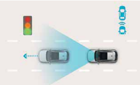
Leading Vehicle Departure Alert (LVDA). Cette fonction intelligente, très utile en ville, avertit le conducteur lorsque le véhicule qui précède quitte l'état stationnaire, par exemple à un feu de signalisation ou dans un embouteillage.
