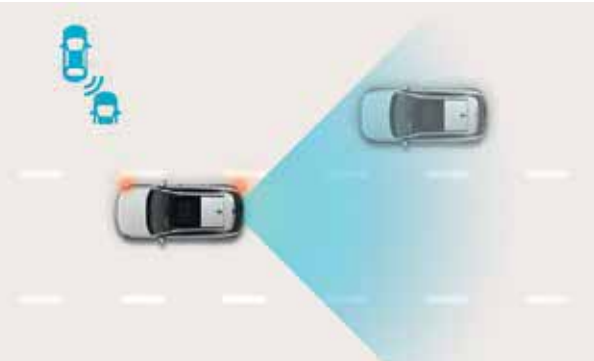
Blind Spot Collision-Avoidance Assist (BCA). Pour plus de sécurité dans une circulation dense, le dispositif BCA vous avertit si une voiture est détectée dans votre angle mort et que vous commencez à changer de voie. Si nécessaire, le système freine et redirige la voiture automatiquement.
