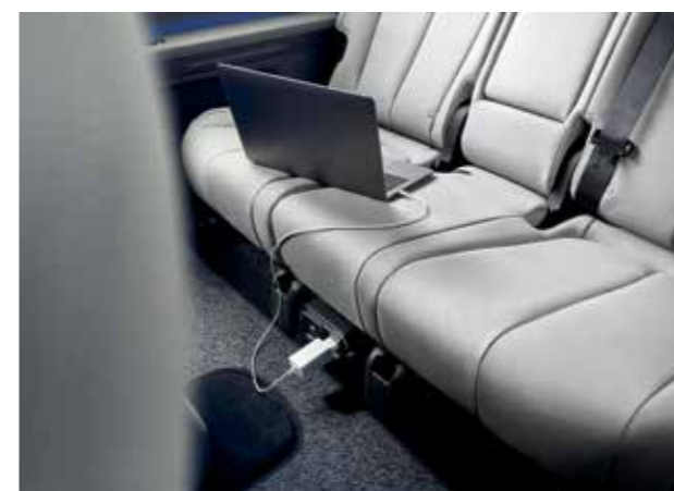
Digital Key 2.0 (ouverture & démarrage avec smartphone compatible) Point de raccordement Vehicle-to-Load intérieur (V2L)
