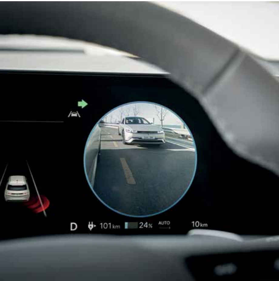
BVM (Blindspot View Monitor), caméra angle mort
