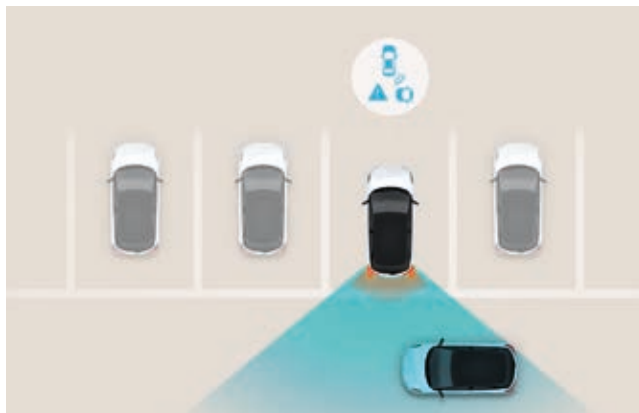
Alerta de aproximación de tráfico trasero activo (RCCA). Al dar marcha atrás en zonas de poca visibilidad, el sistema avisa al conductor si se aproximan vehículos por el lateral y activa los frenos de forma automática.
