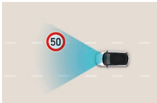
Alerta inteligente de limitación de velocidad (ISLW). Conoce en todo momento cuál es el límite de velocidad. Este sistema utiliza la cámara delantera y los datos del sistema de navegación para identificar las señales de la carretera. A continuación, muestra los límites de velocidad y las prohibiciones de adelantamiento en tiempo real tanto en la pantalla del sistema de navegación como en el panel de instrumentos.
