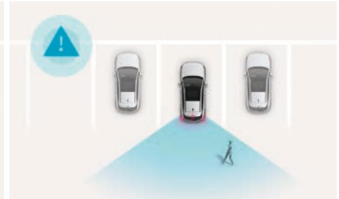
**Sistema de frenado de emergencia con asistente de giro (FCA-JT)**
