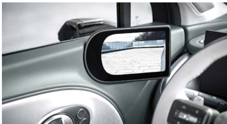
Monitor digitálneho vonkajšieho spätného zrkadla (DSM) na dverách.
