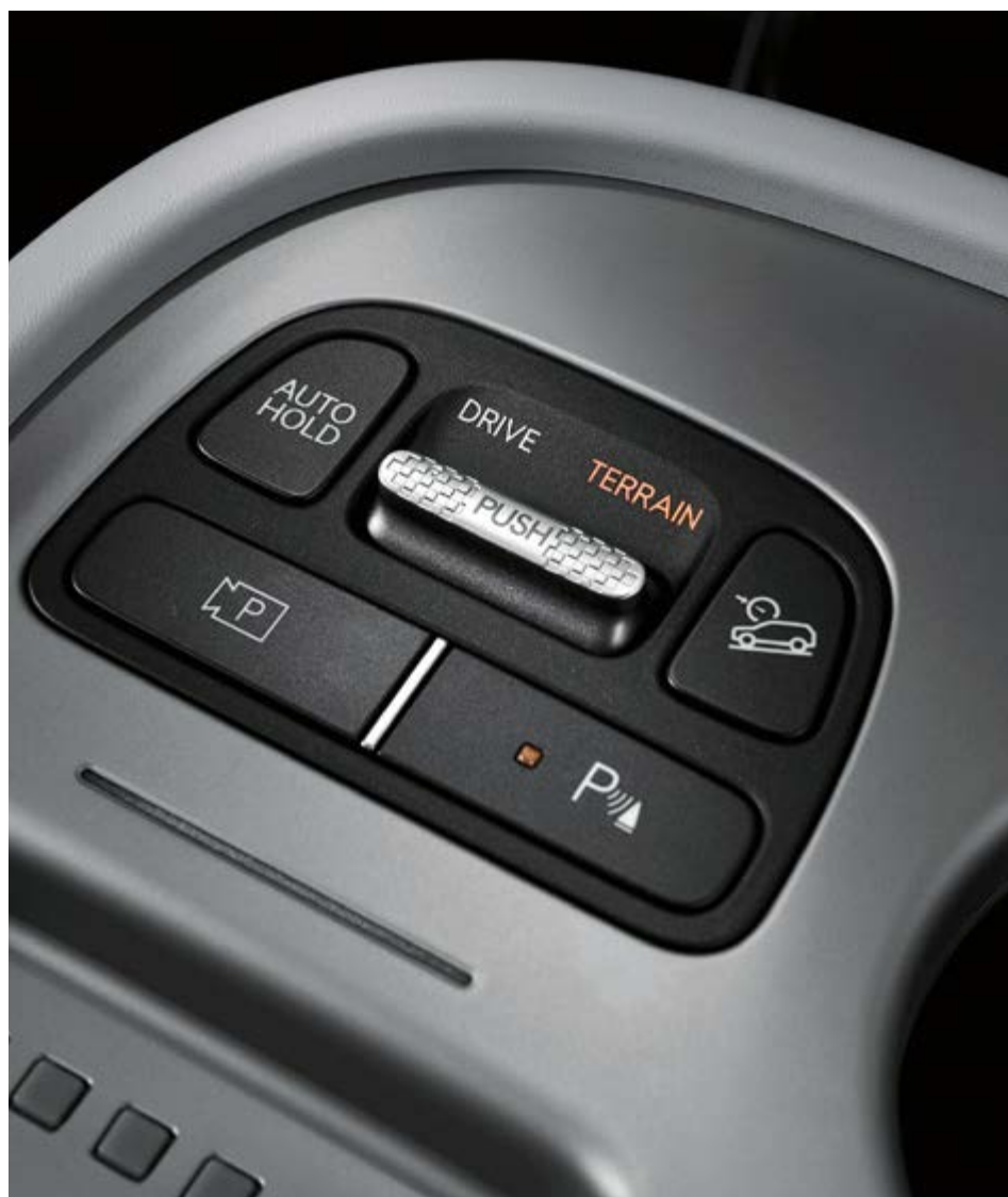
Tlačidlo terénneho režimu s nastaveniami Snow, Sand a Mud.
