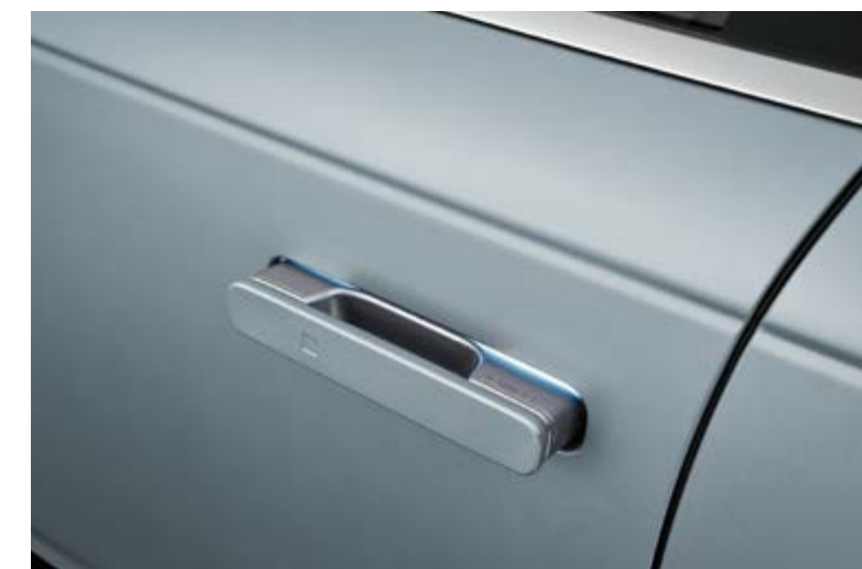
Automaticky výsuvné kľučky dverí.
