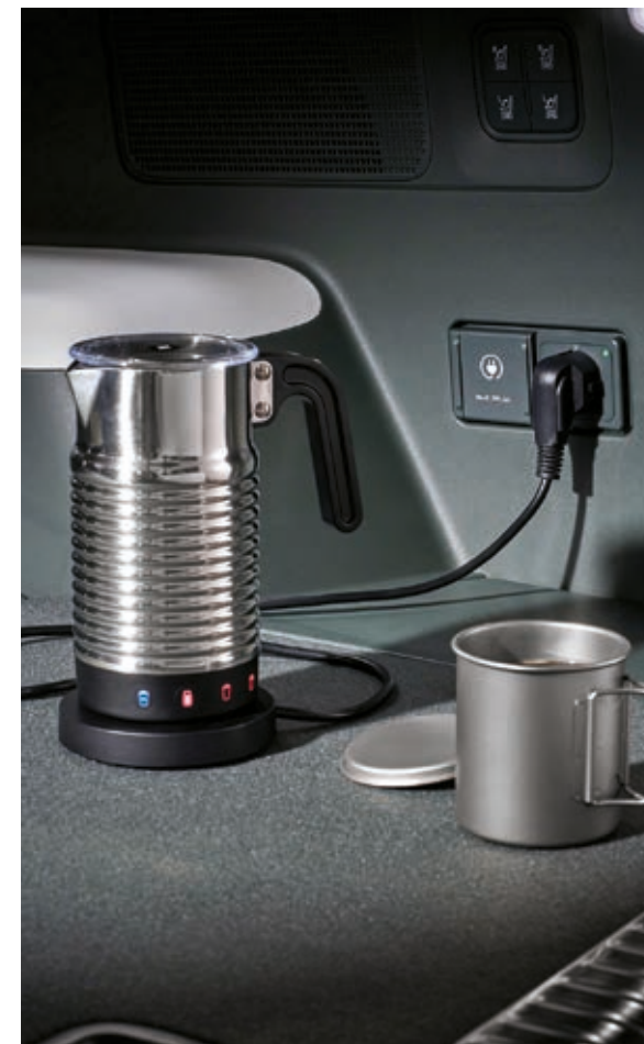
Adaptador interno de carga bidireccional (V2L)
