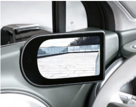
Retrovisor central digital (Visión trasera panorámica) Retrovisor digital (DSM)
