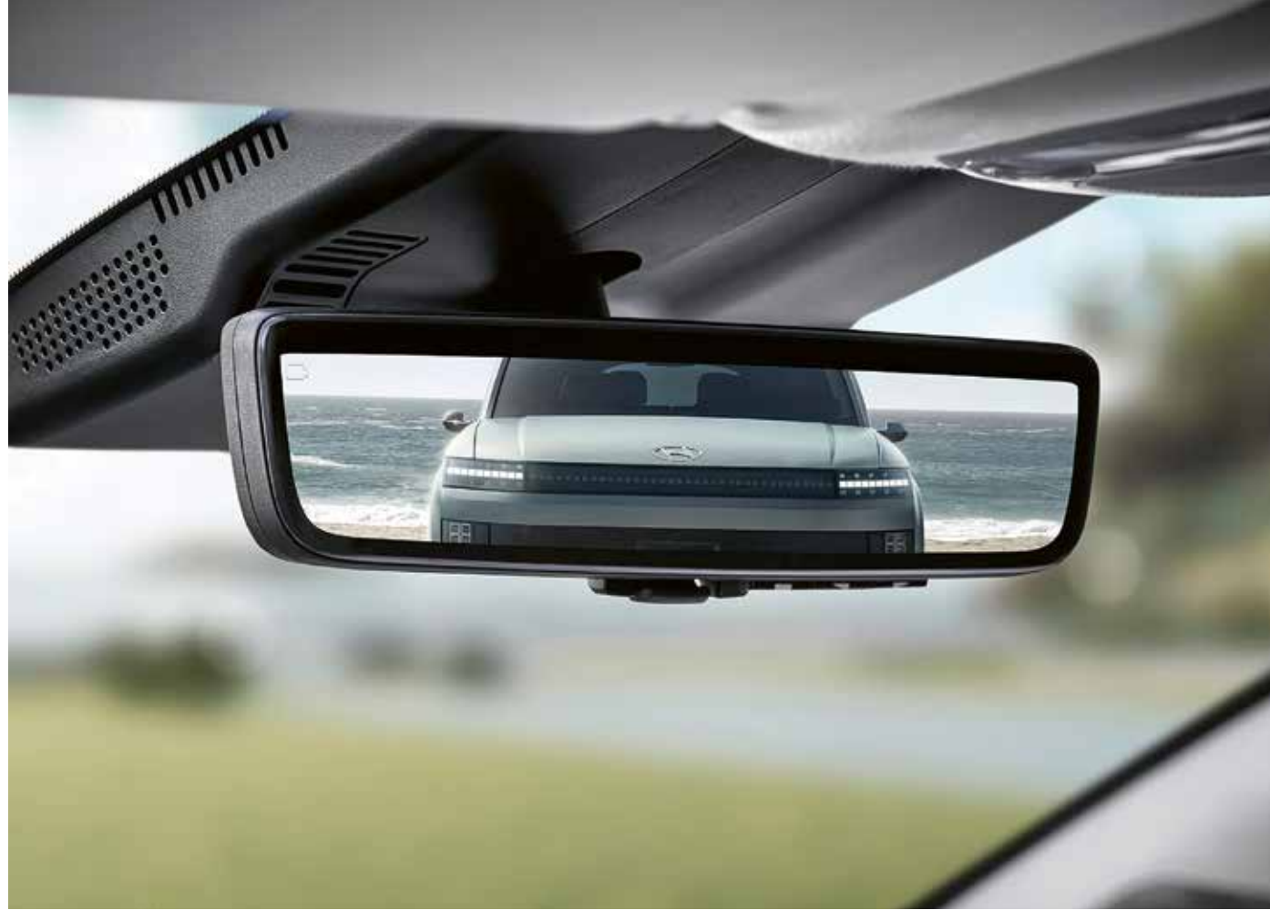
Dijital Dikiz Aynası, etkinleştirildiğinde arkada bulunan kamera yardımıyla aynaya gerçek zamanlı video yansıtır ve çok daha geniş bir görüş alanı sunar.
