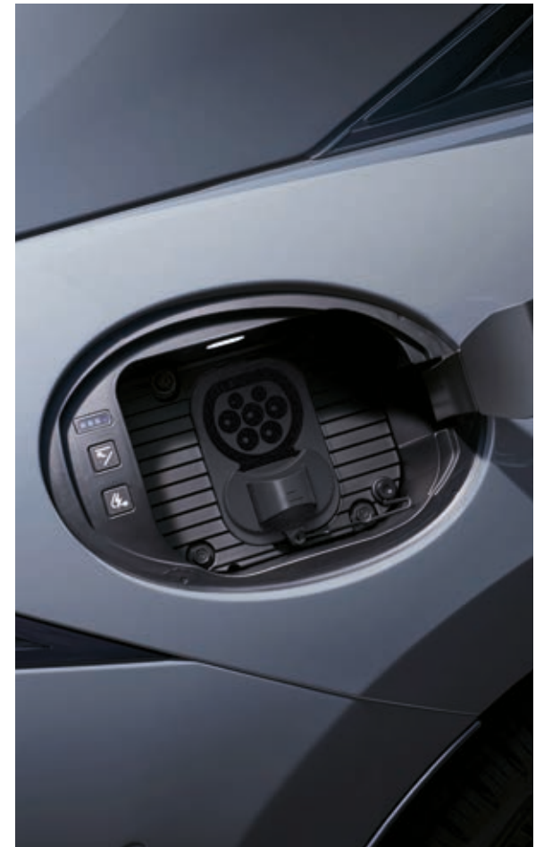
Puerta de carga eléctrica
