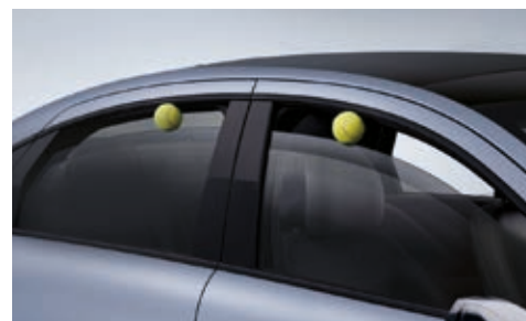
Elevavinas eléctricos de seguridad
