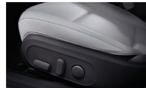
Asiento del conductor con ajuste eléctrico (8 posiciones / soporte lumbar)
