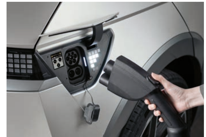
Luces interactivas pixeladas indicando la carga de la batería Puerta de carga eléctrica
