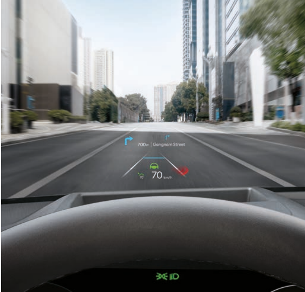
Sistema de proyección de información en parabrisas (HUD)
