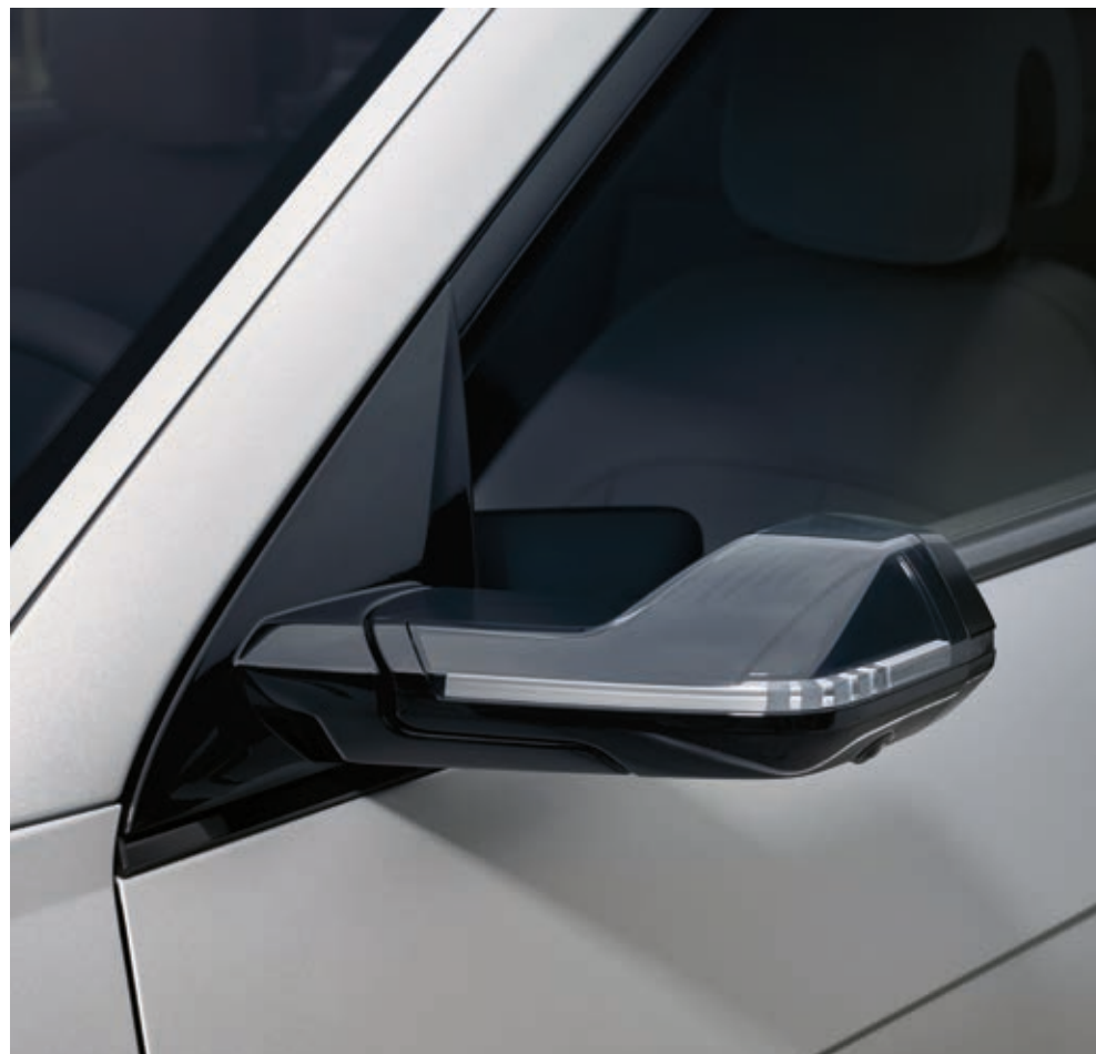
Espejo retrovisor lateral digital aerodinámico (DSM)
