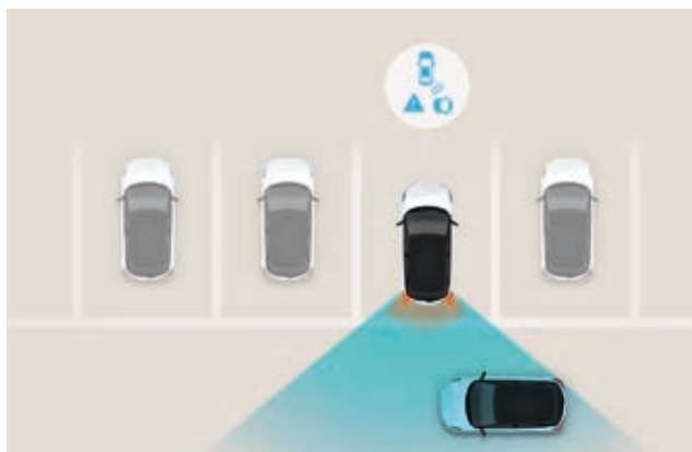
Asistente contra colisiones traseras (RCCA). Perfecto en aparcamientos. Al dar marcha atrás en zonas de poca visibilidad, el sistema avisa al conductor si se aproximan vehículos por el lateral y acciona los frenos de forma automática.
