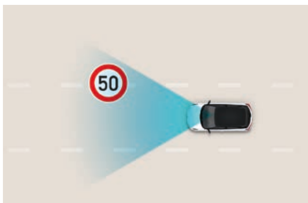
Asistente inteligente de límite de velocidad (ISLA). Las funciones de conducción semiautónoma identifican las señales de la carretera y ajustan la velocidad del coche a los límites establecidos (cuando el sistema está activado).
