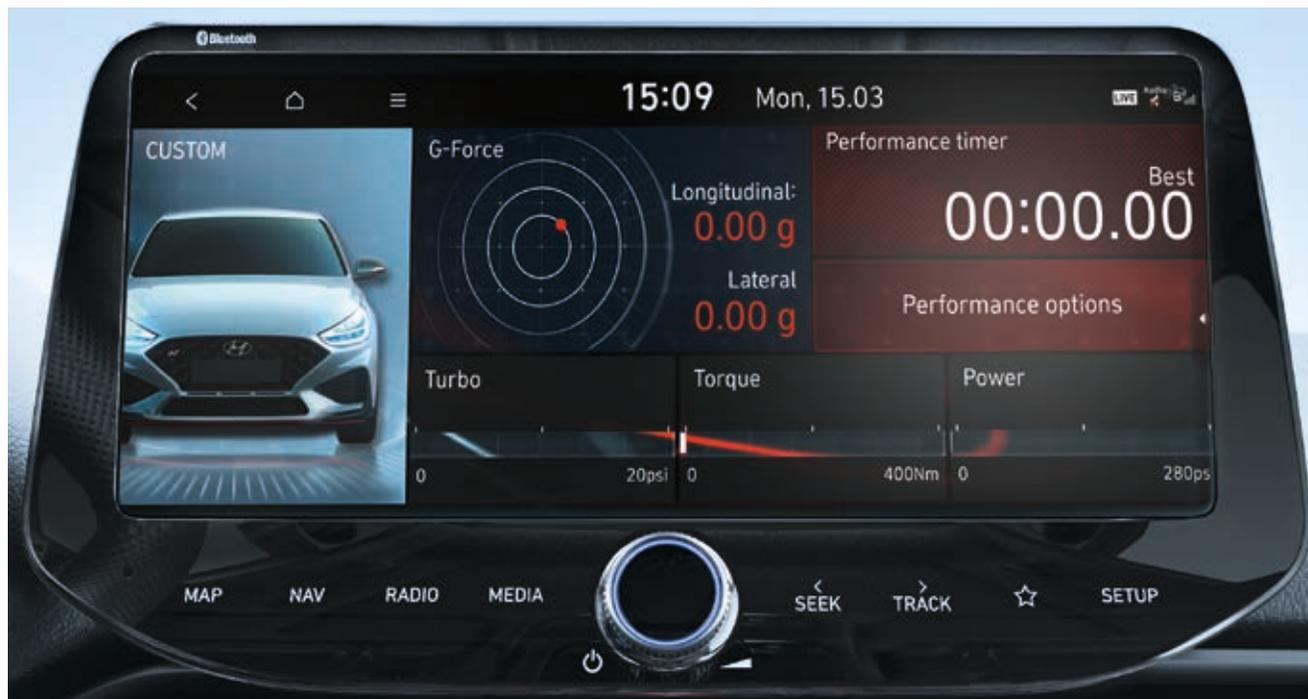
El sistema de datos de rendimiento de la conducción te permite controlar y mejorar tu rendimiento al volante con gráficos optimizados y más fáciles de leer. Se ofrecen datos sobre potencia, par, funcionamiento del turbo y fuerza G, así como cronómetro de vuelta y de aceleración.
