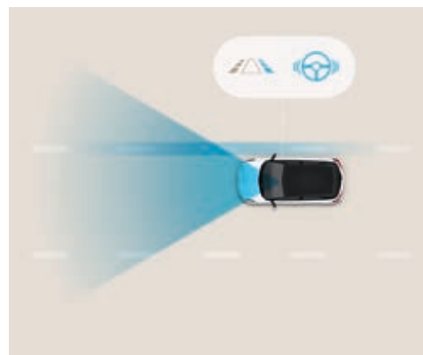
Sistema activo de cambio involuntario de carril (LKA). Este sistema utiliza la cámara frontal para monitorizar las líneas de la calzada. En caso de cambio involuntario de carril, el sistema avisa al conductor e interviene sobre la dirección.
