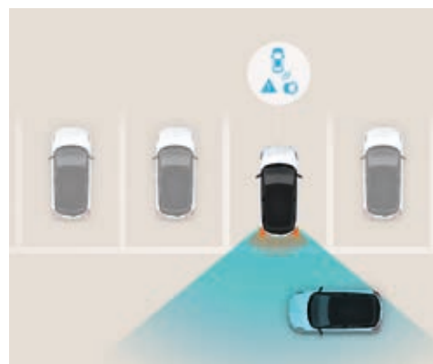
Alerta de aproximación de tráfico trasero activo (RCCW). Al dar marcha atrás en zonas de poca visibilidad, el sistema avisa al conductor si se aproximan vehículos por el lateral (disponible en la versión Hatchback).
