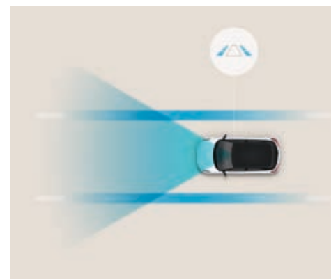
Asistente de seguimiento de carril (LFA). Te mantiene centrado y más seguro. Cuando se activa, este sistema mantiene el vehículo centrado en su carril a velocidades de entre 0 y 180 km/h en ciudad y carretera.
