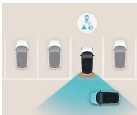
Alerta de aproximación de tráfico trasero activo (RCCW). Perfecto para aparcamientos. Al salir marcha atrás de zonas con poca visibilidad, el sistema te avisa si se acercan vehículos por el lateral o por detrás con una alerta visual y sonora.
