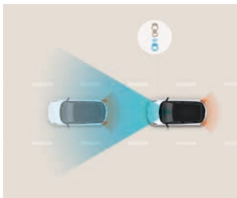
Sistema de asistencia a la frenada de emergencia en ciudad (FCA). El sistema FCA te avisa y frena automáticamente cuando detecta una colisión inminente con el coche que te precede o detecta peatones o ciclistas.
