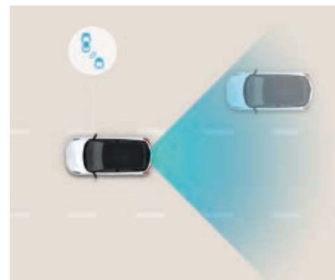
Sistema de detección de ángulo muerto (BCW). ¡Adiós a los ángulos muertos! Los sensores vigilan los laterales y la parte trasera y te avisan con una advertencia en el espejo retrovisor si hay un vehículo en tu punto ciego. Si utilizas los intermitentes, suena un aviso acústico.
