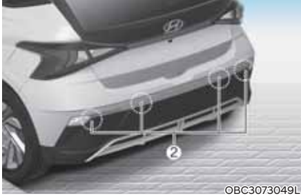
[1]: Ön ultrasonik park sensörleri [2] : Arka ultrasonik park sensörleri
