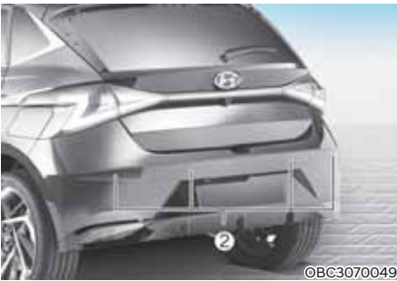
[1]: Arka görüş kamerası, [2]: Arka ultrasonik park sensörleri
