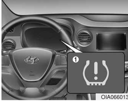
(1) Düşük lastik basıncı göstergesi / TPMS arıza göstergesi
