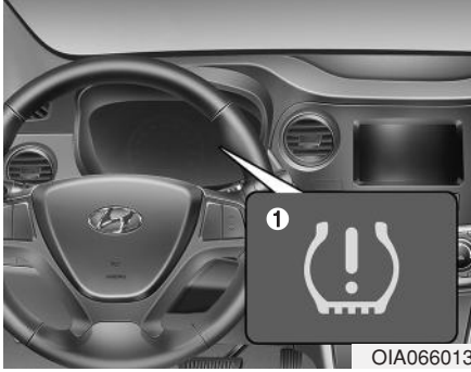
(1) Düşük lastik basıncı göstergesi / TPMS arıza göstergesi
