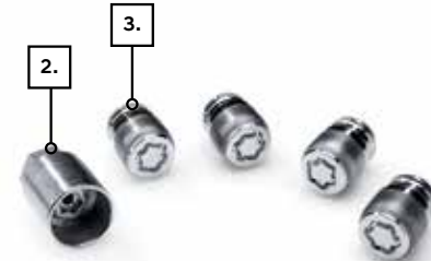
2. Adapterschlüssel Aufsatz für den serienmäßigen Radmutter- schlüssel zur Montage und Demontage der Hyundai Leichtmetallfelgen. SW21 auf SW19. 9999Z05009
