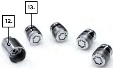
12. Adapterschlüssel Aufsatz für den serienmäßigen Radmutterschlüssel zur Monta- ge und Demontage der Hyundai Leichtmetallfelgen. SW21 auf SW19 9999Z05009
