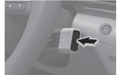
Das Fahrzeug durch Drücken der Taste „P“ am Drehschalter in die P-Stellung (Parken) bringen.
