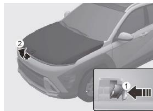
Sekundäre Verriegelung (①) in der Mitte der Haube nach oben ziehen und Haube (②) anheben.
