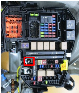
Entriegelungshebel zur Entriegelung der Motorhaube ziehen.
