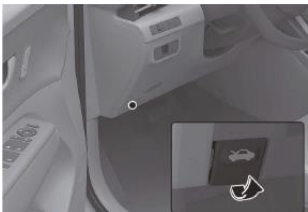
Entriegelungshebel zur Entriegelung der Motorhaube ziehen.
