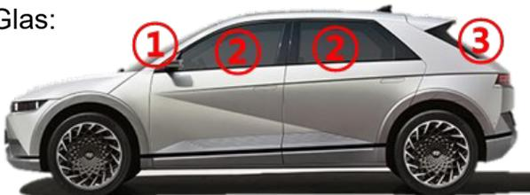
1 : Beschichtet / 2 : Gehärtet, Beschichtet (OPT) / 3 : Gehärtet
