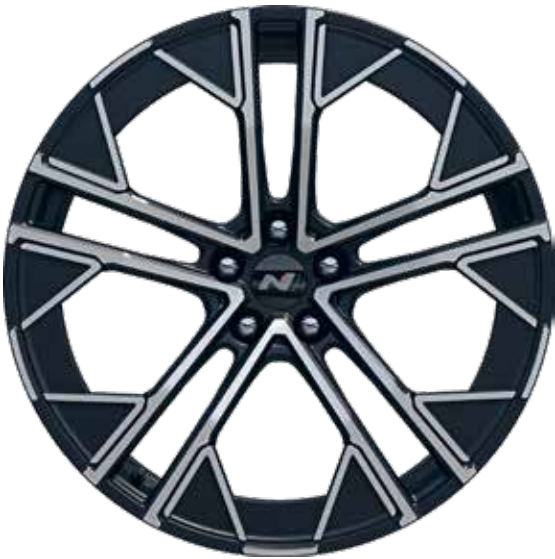
9,5 J x 21-Zoll-Schmiedefelgen mit 275/35 R 21-Bereifung
