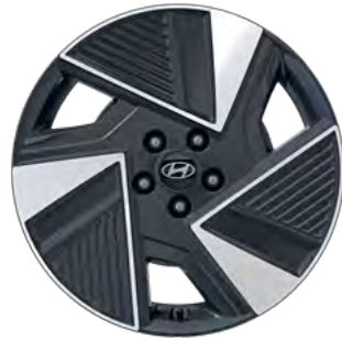
7,5 J x 19-Zoll-Leichtmetallfelgen mit 235/55 R 19 Bereifung
