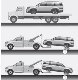
Hinweis: Die Verwendung von Rollböcken (1) oder einer Pritsche wird empfohlen. Verwenden Sie einen Wagenheber oder eine Pritsche.
