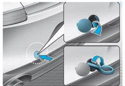
Der Abschlepphaken befindet sich im Werkzeugkoffer im Kofferraum.
