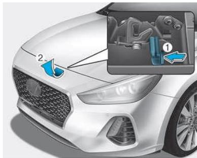
Heben Sie die Motorhaube leicht an, drücken Sie die sekundäre Verriegelung (1) in der Mitte der Haube nach oben und heben Sie die Haube (2) an.
