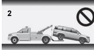
Hinweis: Nicht mit Gurten abschleppen (1). Schleppen Sie das Fahrzeug nicht mit den Vorderrädern auf dem Boden ab, da dies zu Schäden am Fahrzeug führen kann (2).
