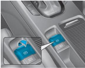
1. Verkeilen Sie die Räder und ziehen Sie den **EPB**-Schalter, um die Feststellbremse zu aktivieren.
