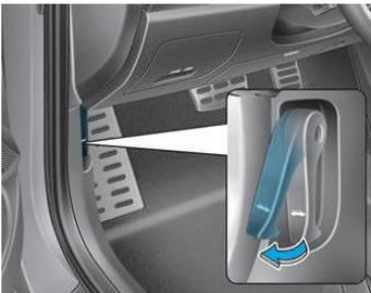
Ziehen Sie den Entriegelungshebel zur Entriegelung der Motorhaube. Die Motorhaube sollte leicht aufspringen.
