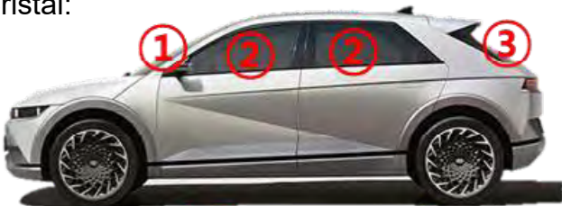
1 : Laminado / 2 : Templado, Laminado (OPT) / 3 : Templado
