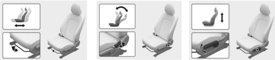
**Eléctrico: El asiento delantero puede ajustarse mediante el mando de control.**
