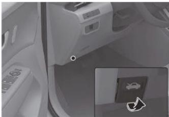
Tire de la palanca de desbloqueo para abrir el capó.
