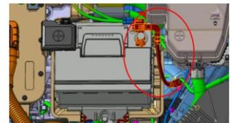
Desconecte el terminal negativo (-) de la batería auxiliar 12.
