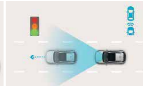
Leading Vehicle Departure Alert (LVDA). Rij zonder moeite in de stad dankzij deze technologie. Als een voorligger terug vertrekt vanuit stilstand (aan een stoplicht of in een file bijvoorbeeld), word je als bestuurder gewaarschuwd door het systeem.
