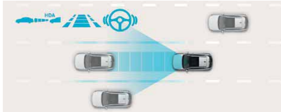
Highway Driving Assist (HDA). De KONA Electric is uitgerust met Highway Driving 1.5 dat via sensoren en kaartinfo de wagen binnen zijn rijvak houdt en op een veilige afstand blijft ten opzichte van voorliggers. Daarbij wordt de snelheid automatisch aangepast.
