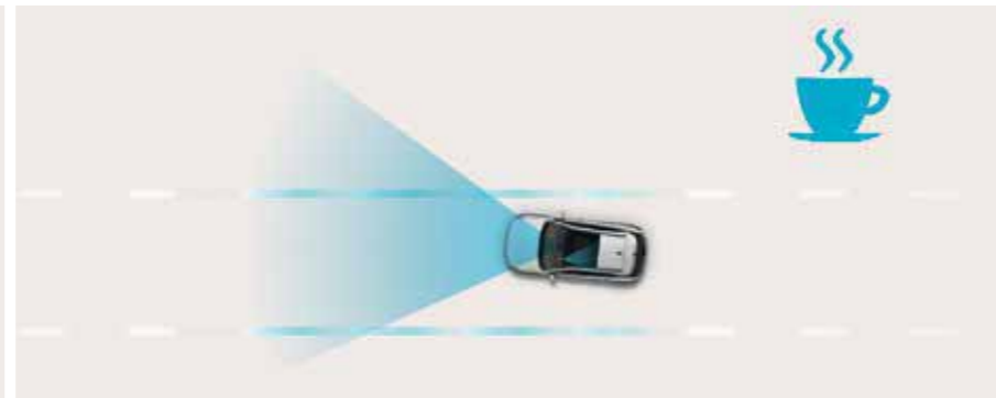
In Cabin Camera (ICC). Via een camera in de wagen wordt het gezicht van de bestuurder geanalyseerd. Wordt er vermoeidheid of afleiding vastgesteld? Dan krijgt de bestuurder een visueel en auditief waarschuwingssignaal.
