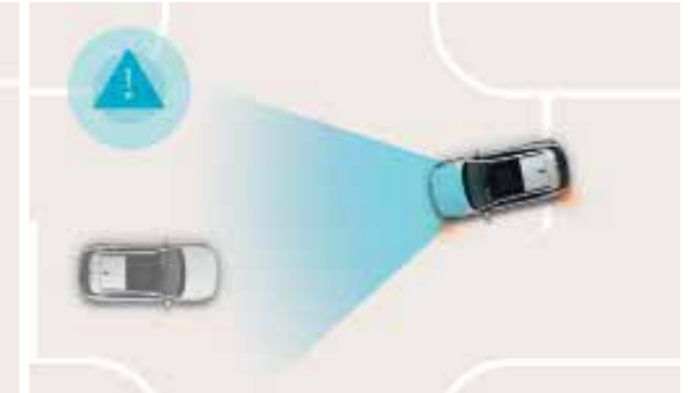
Forward Collision-Avoidance Assist met Junction Turning (FCA-JT). Met behulp van een camera en een radar scant het systeem de weg en zorgt het ervoor dat de wagen automatisch vertraagt wanneer een voorligger brusk remt of kans is op een aanrijding met voetgangers of fietsers. Op kruispunten remt de wagen in geval van een mogelijke aanrijding met een tegenligger.
