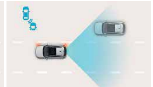
Blind Spot Collision-Avoidance Assist (BCA). Voor veiliger rijden in druk verkeer waarschuwt BCA je als er een wagen wordt gedetecteerd in je dode hoek en je van rijvak verandert. Indien nodig zorgt het ervoor dat de wagen automatisch afremt en bijstuurt.
