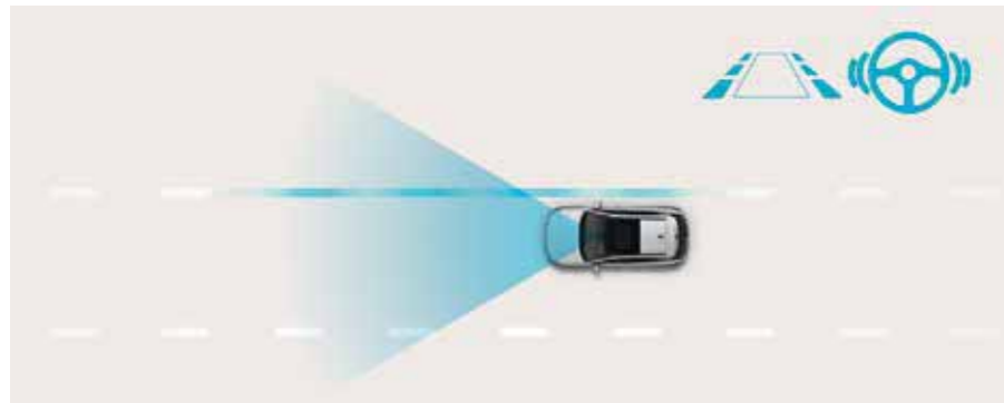
Lane Keeping Assist (LKA). Met behulp van de multifunctionele camera vooraan waakt de wagen permanent over de lijnen van de rijvakken. Als je onbedoeld van je rijvak afwijkt, waarschuwt het systeem je en kan het zelfs automatisch bijsturen om je in het juiste vak te houden.
