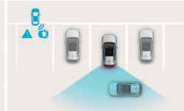
Rear Cross-Traffic Collision-Avoidance Assist (RCCA). Ideaal voor parkeerterreinen. Bij het uitrijden uit plaatsen met weinig zichtbaarheid, waarschuwt het systeem je als er voertuigen van opzij naderen en worden de remmen automatisch geactiveerd.
