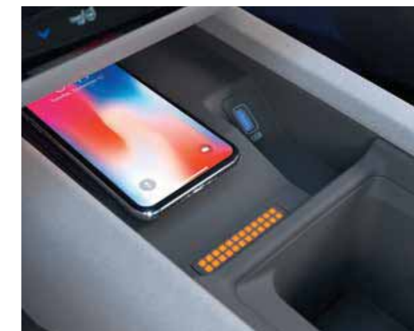
Het draadloze laadstation voor je smartphone laadt supersnel en toont via Parametrische Pixels de laadstatus.
