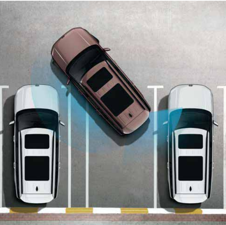
Forward/Side/Reverse Parking Distance Warning (PDW) prévient des risques de collision avec des objets situés autour de la voiture à basse vitesse.
