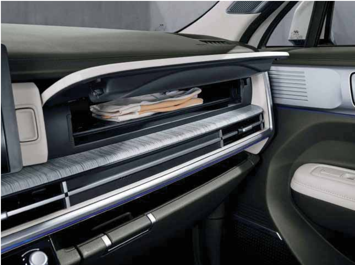
Plateau de stérilisation UV-C ; situé au-dessus de la boîte à gants, il permet de stériliser facilement les objets fréquemment utilisés, tels que les smartphones et les portefeuilles.
