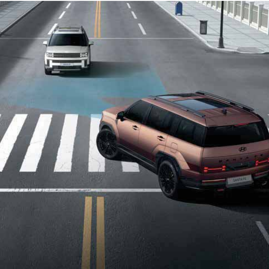
Forward Collision-Avoidance Assist 2 (FCA 2) surveille votre environnement et vous avertit en cas de risque de collision. Après l'avertissement, le système effectue automatiquement un freinage d'urgence en cas de risque de collision accru – avec un véhicule venant en sens inverse ou un deux-roues motorisé lors d'un virage à gauche à un croisement, avec un véhicule venant en sens inverse par la gauche ou par la droite, ou lors d'un changement de voie. Il aide automatiquement à effectuer une manœuvre d'évitement en cas de risque de collision avec un véhicule ou un deux-roues motorisé arrivant en sens inverse ou se rapprochant sur la voie suivante lors d'un changement de voie, avec un véhicule/piéton/cycliste se trouvant partiellement sur la trajectoire prévue du véhicule, ou avec un véhicule se trouvant à l'arrière lors d'un changement de voie.
