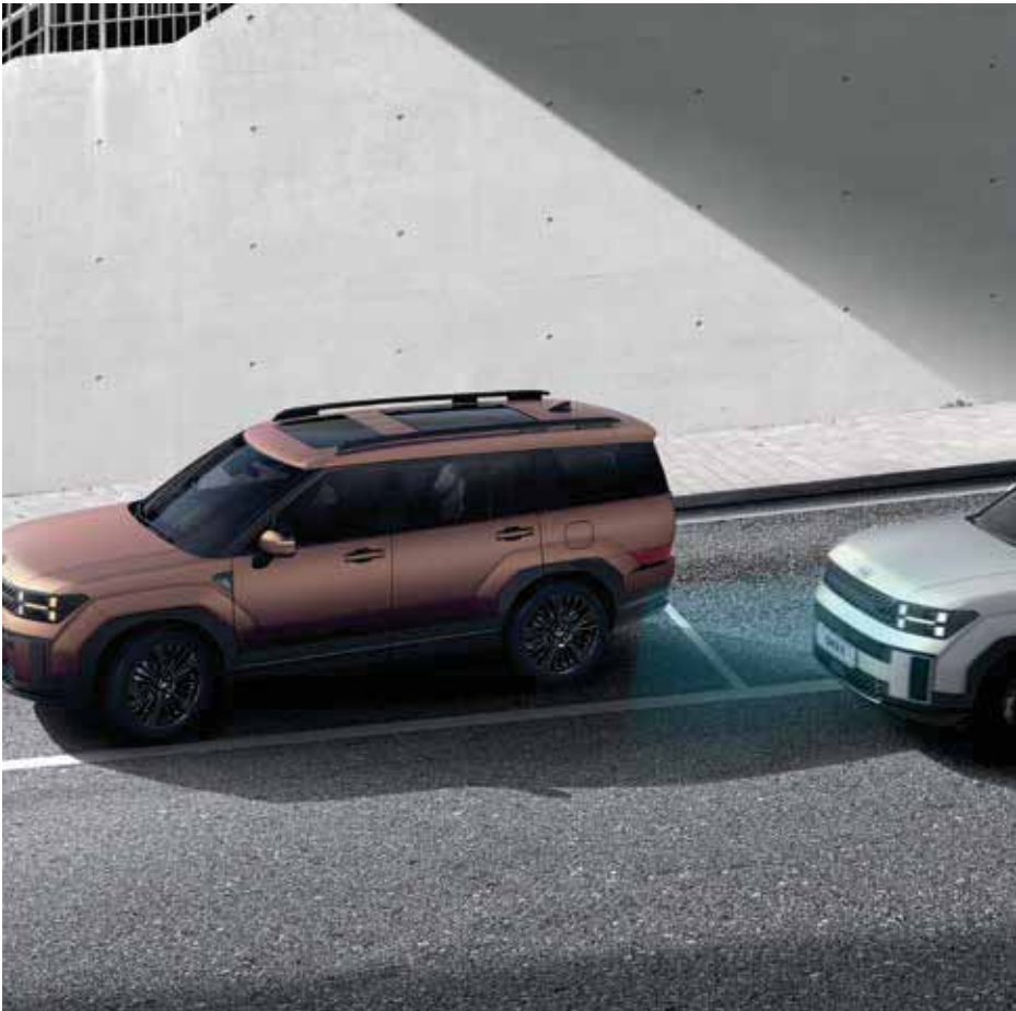
Blind-Spot Collision-Avoidance Assist (BCA) vous avertit en cas de risque de collision avec un véhicule arrivant par l'arrière dans l'angle mort lors d'un changement de voie. Lorsque l'on quitte une place de stationnement parallèle vers l'avant, s'il y a un risque de collision avec un véhicule arrivant par l'arrière, il aide automatiquement au freinage d'urgence.
