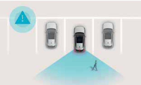
Reverse Parking Collision-Avoidance Assist Reverse (PCA-R). Si un obstacle est détecté via la caméra de recul ou les capteurs à ultrasons arrière lors d'une marche arrière, le PCA vous avertit et freine automatiquement si nécessaire.
