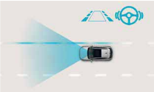
Lane Keeping Assist (LKA). À l'aide de la caméra multifonction située à l'avant, la voiture surveille en permanence les lignes des voies. Si vous déviez involontairement de votre voie, le système vous avertit et peut même intervenir automatiquement pour vous maintenir dans la bonne voie.
