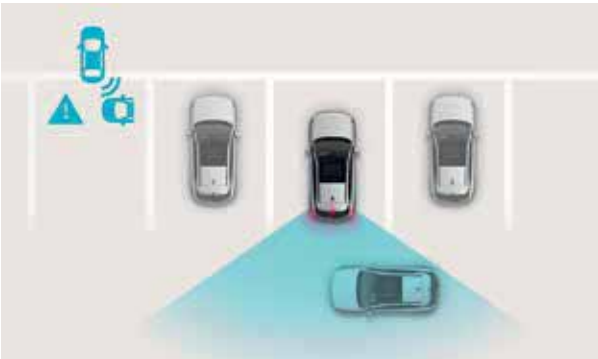
Rear Cross-Traffic Collision-Avoidance Assist (RCCA). Idéal pour les parkings. En situation de marche arrière dans des zones à faible visibilité, le système avertit le conducteur si des véhicules approchent depuis les côtés, et actionne automatiquement les freins.
