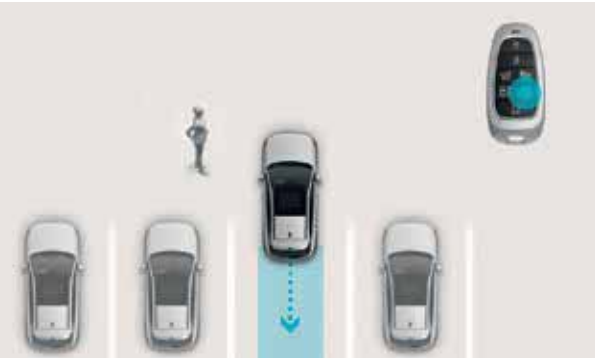
Remote Smart Parking Assist (RSPA). Garez-vous plus facilement dans les espaces de stationnement étroits avec RSPA. Sortez et manœuvrez le KONA Hybrid vers l'avant et vers l'arrière avec les boutons-poussoirs Smart Key pendant que vous regardez à distance.
